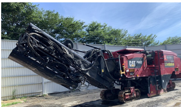
大型道面刨除機
